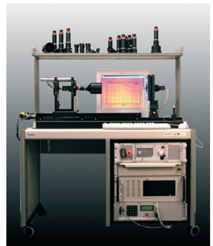
Bild 1. OptoMess-Arbeitsplatz: Der Messplatz wurde bei IB/E entwickelt, um die eigene Produktion telezentrischer Messobjektive zu protokollieren
